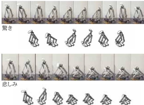
図17 部分試作による6感情ごとの感情を伝える動き(上:実機下:CG)
