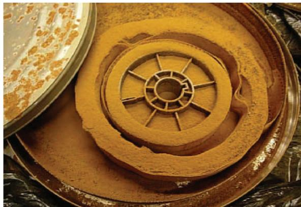
劣化したナイトレート・フィルム、硝酸ガスで缶の鉄が酸化し付着
