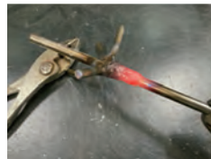
写真12) 溶接による肉盛り
