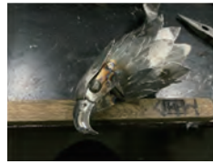
写真 19) 嘴を内から溶接
