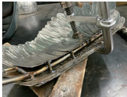
写真7) 翼の内部のフレーム
