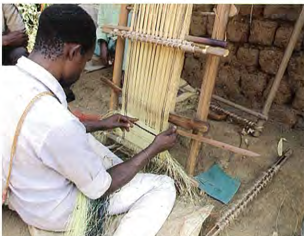
写真13 文様刀杼でタテ糸をすくいあげ、ここに色糸を入れ文様を織る
