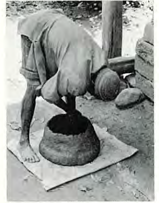
ビニール膜の上に置いたリング状の粘土を掻き上げる
