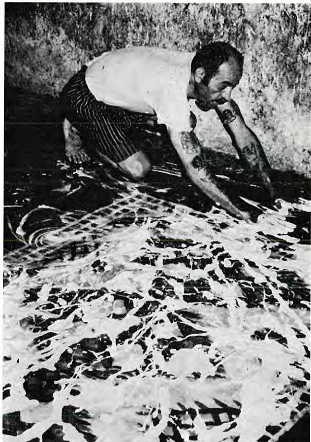
〔写真18〕 模様のある表側を上にして、点検した後、全面に石鹼泡を塗布する作業
