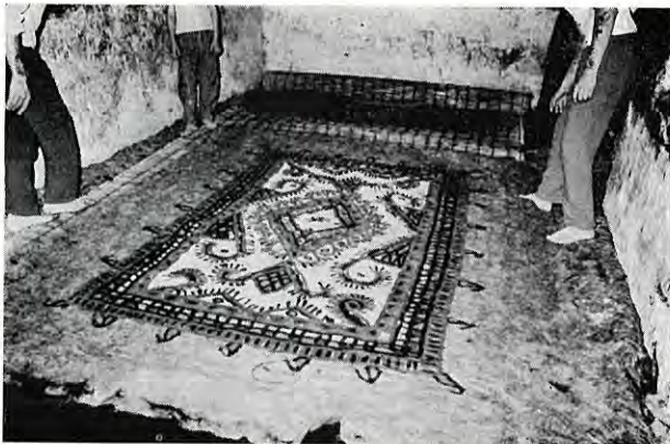
〔写真16〕 足で圧縮されたハシール(Hashir)を解くと厚さ約1センチばかりのフェルト状態になった羊毛
