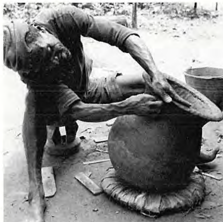
ほぼでき上った壺形の土器、たんねんに口づくりをする
