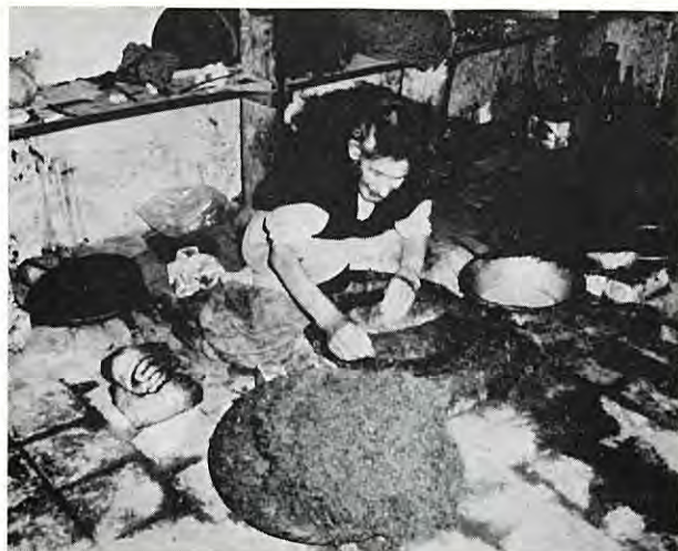
〔写真1〕 炉の上に置いた金属皿の上に羊毛を乗せ、石鹼泡を塗布して、羊毛のせんべいをつくる作業。
