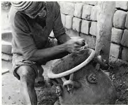
カキベラで内部を削り、器壁を整える
