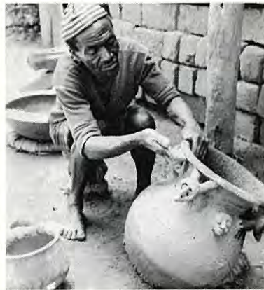
全体に黄土で化粧掛けをし、 小石でで磨き滑らかにする
