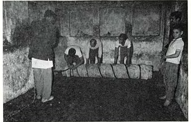
〔写真13〕 ハシール (Hashir) を回転させながら紐をかける作業
