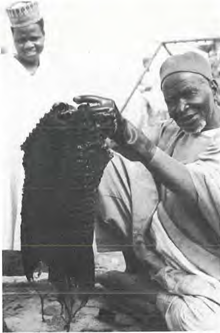
写真11 アデレ布の染色。藍ガメの中で布に染料を吸収させた後、空気酸化させて発色
