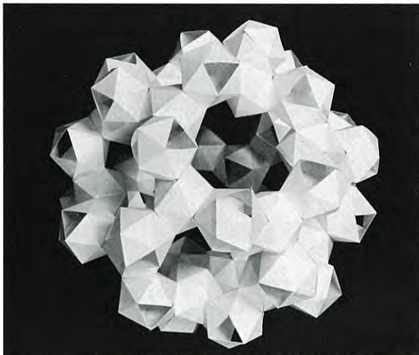
図12 Icosahedronのみで構成される空間構造体
