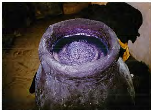
写真6 藍建て用カメで発酵した染液を、染色用カメに移し、硫化バットを少量加えて攪拌し、翌朝までおく。
