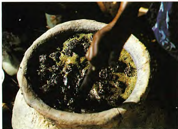
写真5 発酵のすすんだ藍ガメを攪拌すると緑色の泡がはげしくたち始める。
