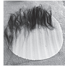
写真11) 発砲シート・中敷の上に ウールを並べる
