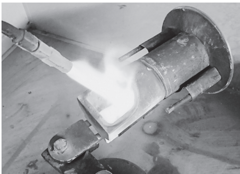
写真3 銀を溶解し、遠心力で鋳型に流し込む。
